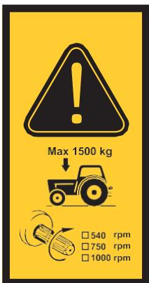
Нагрузка на трактор должна составлять не более 1500 кг. Пожалуйста, будьте осторожны, чтобы частота вращения вала отбора мощности не снижалась ниже 540 об / мин.
